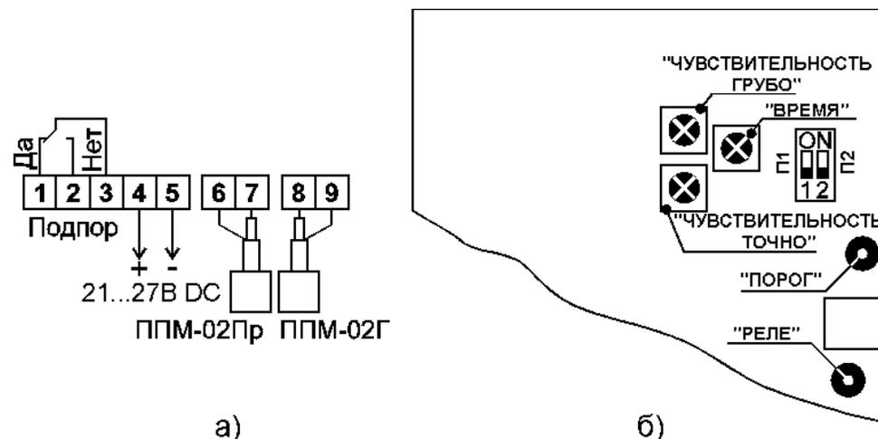
Рис. 7. Схема подключения и органы регулировки датчика РСУ-1А.
